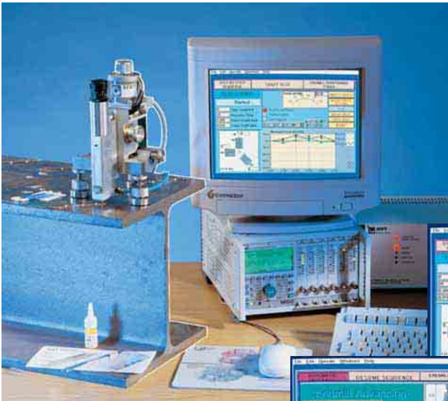
Komplett-Messkette mit Messverstärker sowie Steuer- und Auswert PC
